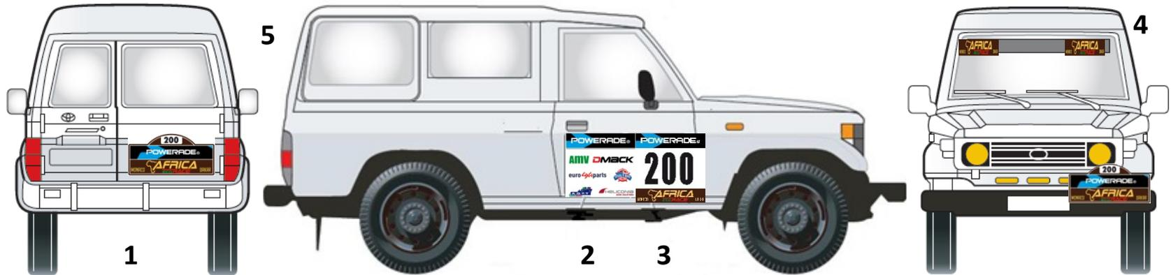
1 – 2 Rally plates, 43 x 21.5 cm, at the front and rear of the vehicle / 2 плашки ралли, 43 x 21,5 см, на передней и задней части транспортных средств согласно схеме
