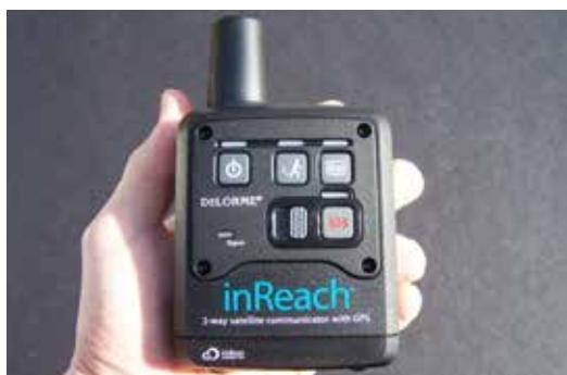
**InReach** – спутниковый прибор обеспечения безопасности. Используется организаторами для мониторинга места нахождения участников в соревнованиях, проводимых в регионах с отсутствием покрытия сотовой связи на СУ. Позволяет отправлять сообщения SOS и OK организаторам по каналу спутниковой связи.
