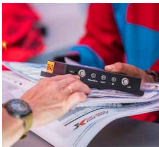
**Оборудование контроля трека GPS прибор SMM** – спутниковый прибор, устанавливаемый организатором на технику участника для записи GPS-трека и фиксирующий прохождение всех путевых точек маршрута согласно дорожной книге. Записанный трек непрерывно передаётся на сервер Wialon по GPRS-каналу. При прохождении контрольных точек маршрута WPE/WPS GPS прибор SMM с помощью диодной индикации сообщает участнику о вхождении в зону контрольной точки маршрута.
